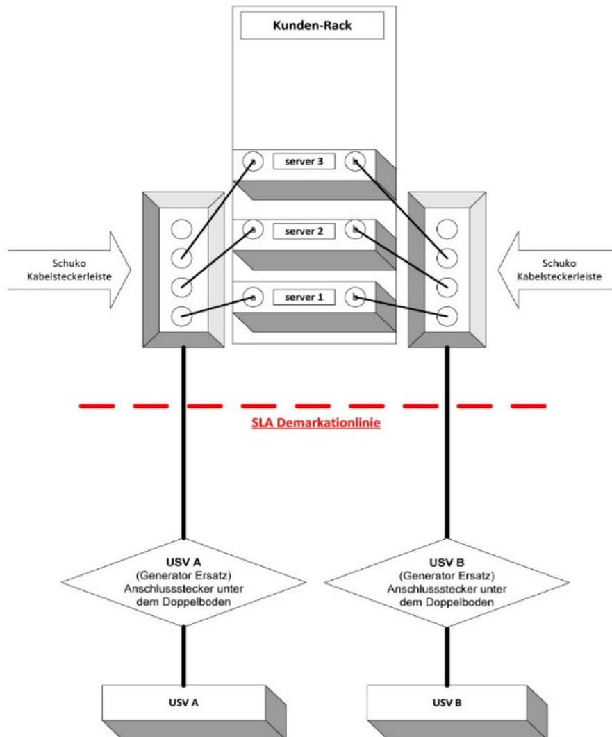
Für jedes Kunden-Rack wird mindestens eine USV A Zuleitung und eine USV B Zuleitung bereitgestellt. Diese Zuleitungen schließen mit Mehrfachsteckdosen ab. Es wird vorausgesetzt, dass jedes Kundengerät eine duale Netzeinspeisung hat. Die Summe der Strombelastung für beide Zuleitungen sollte 13 Ampere (3 KW) nicht überschreiten. Jeder Zuleitung ist seitens TC mit Leistungsschutzschaltern mit Charakteristik C, 16A abgesichert.
