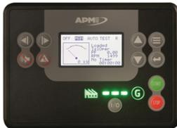
Die Steuereinheit APM403 ist ein Mehrzweckmodul, das im manuellen oder automatischen Modus betrieben werden kann.
